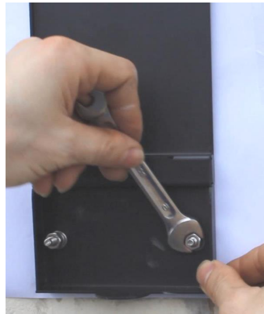
6. Serrez les vis inférieures avec une clé.
