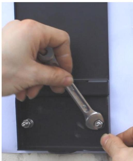
6. Serrez les vis inférieures avec une clé.
