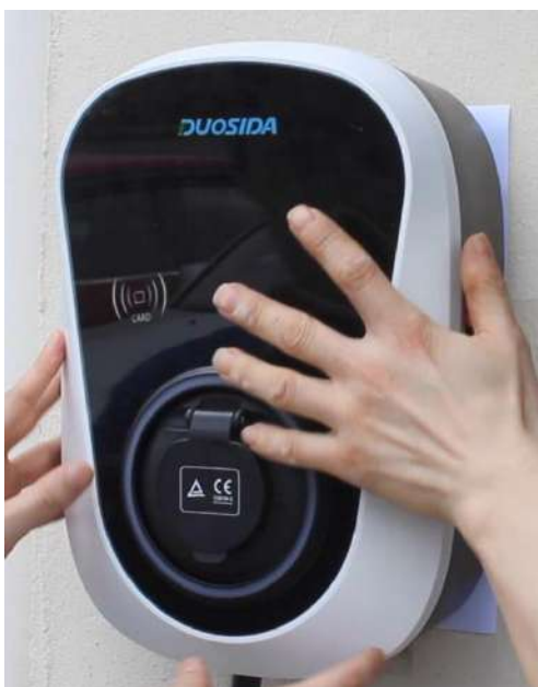
7. Accrochez le corps principal de la station de charge sur le support.
