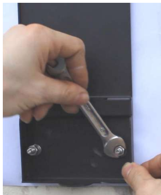
6. Serrez les vis inférieures avec une clé.
