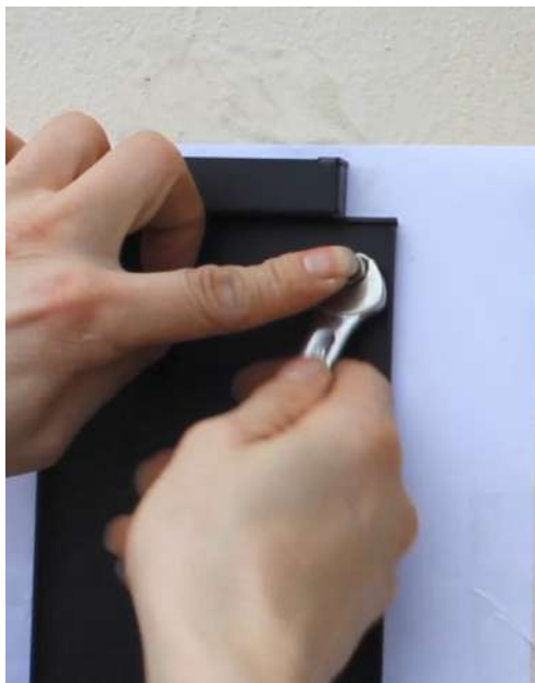
5. Serrez les vis supérieures avec une clé.
